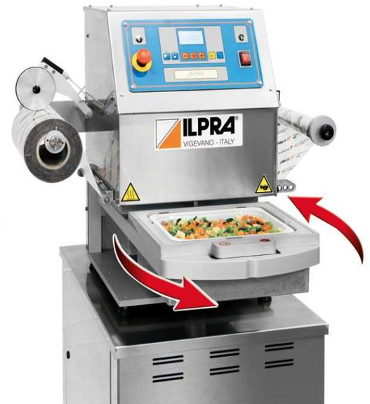
Realizada en acero inoxidable y aluminio anodizado, está perfectamente adaptada para trabajar con una tasa alta de humedad. Con protección IP 44 cumple con las normativas comunitarias a nivel de protecciones.
